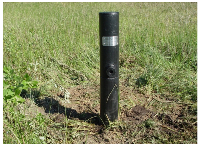
Peilbuislocatie met beschermkoker voorzien van RVS- codeplaatje.
