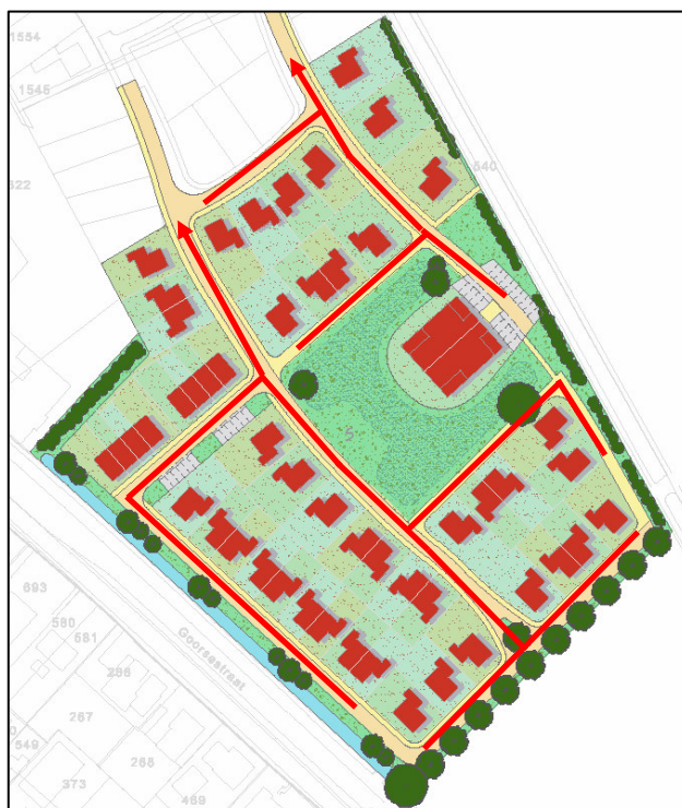
Figuur 4.8: structuur droogweer afvoer
