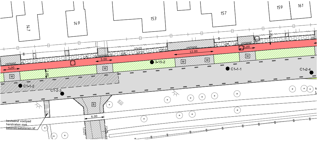
Afbeelding 46. Ontwerp gemeente Haaksbergen: parkeerzone in berm ter hoogte Enschedesestraat 147-161.
