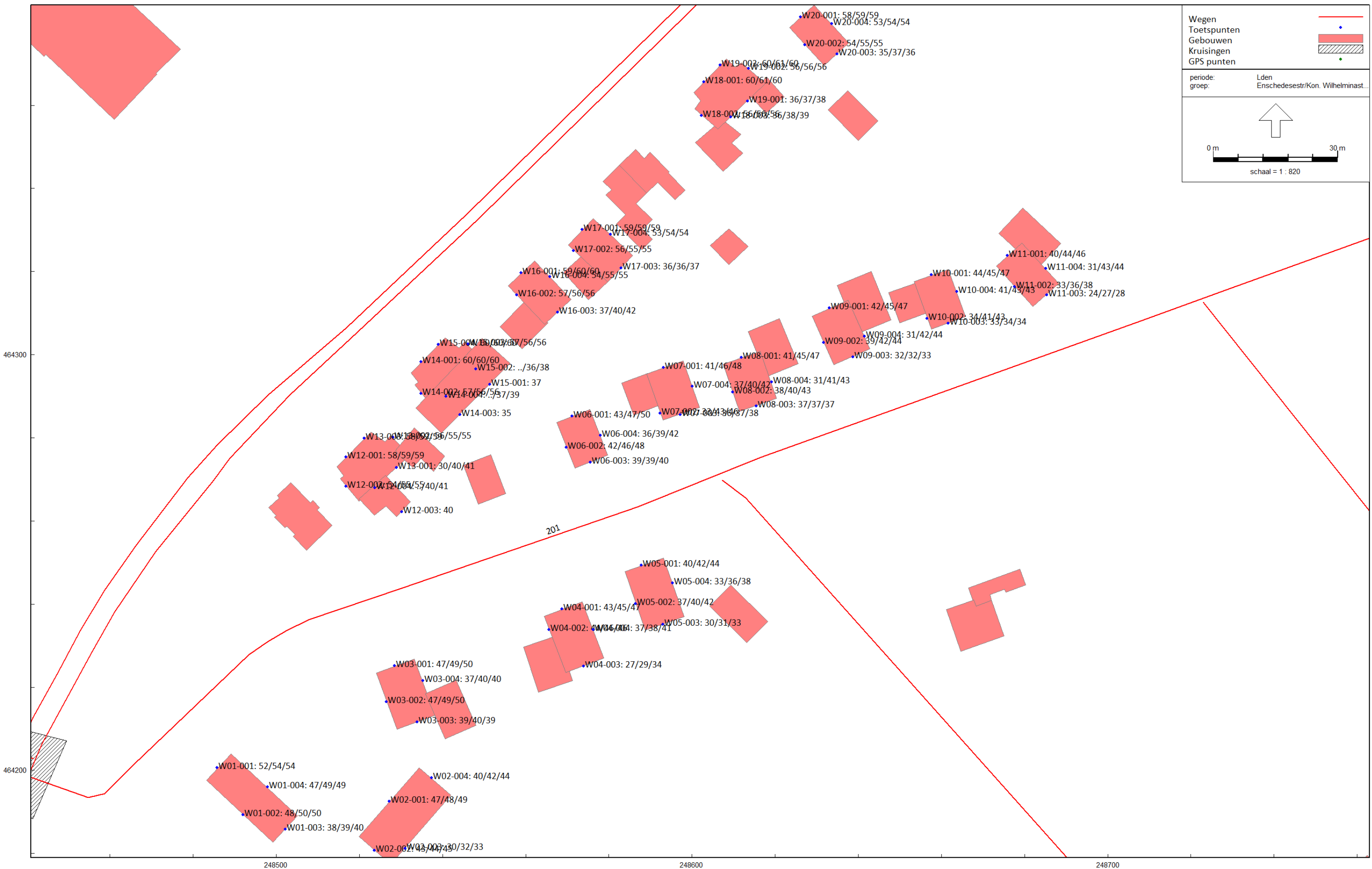
Figuur 3 Geluidsbelastingen vanwege wegverkeer op de Enschedesestraat/Koningin Wilhelminastraat voor afwaardering. In verband met de variabele correctie, exclusief correctie conform Wgh. Correcties: 56 dB-3 dB, 57 dB-4 dB, overige geluidsbelastingen -2 dB. Beoordelingshoogte 1,5 / 4,5 en 7,5 meter
