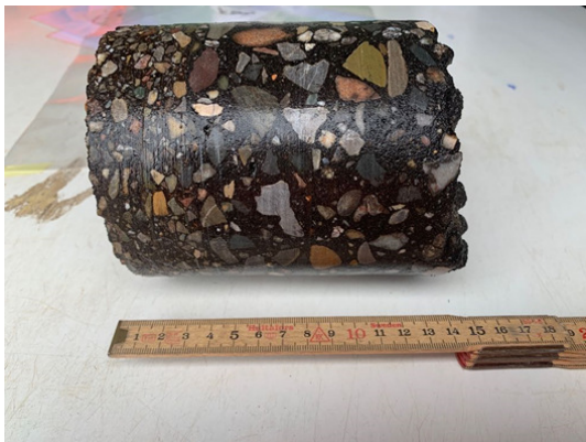
Afbeelding 11. Boring B09, laag 0-0,15 m
