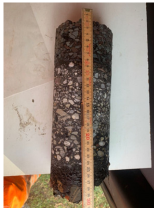
Afbeelding 24. Boring B25, laag 0-0,31 m
