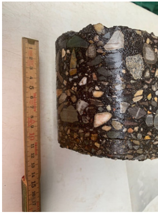
Afbeelding 7. Boring B03, laag 0-0,11 m
