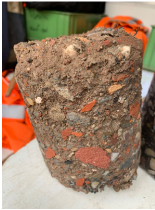
Afbeelding 13. Boring B12, laag 0,12-0,5 m
