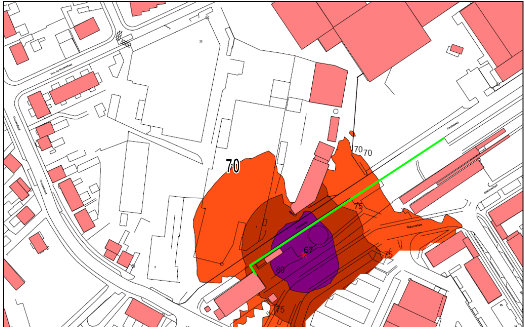
Figuur 13 Contouren maximale geluidsniveaus (etmaalwaarde) MBS – schermhoogte 2,5 meter, beoordelingshoogte 7,5 meter (3 e verdieping)
