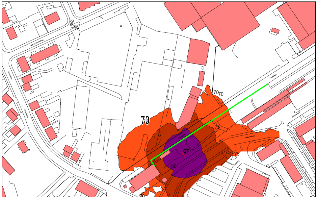
Figuur 14 Contouren maximale geluidsniveaus (etmaalwaarde) MBS – schermhoogte 4 meter, beoordelingshoogte 7,5 meter (3 e verdieping)
